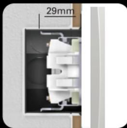
Die Krallen ermöglichen eine tiefere Befestigung (auch an Fliesen usw.).
